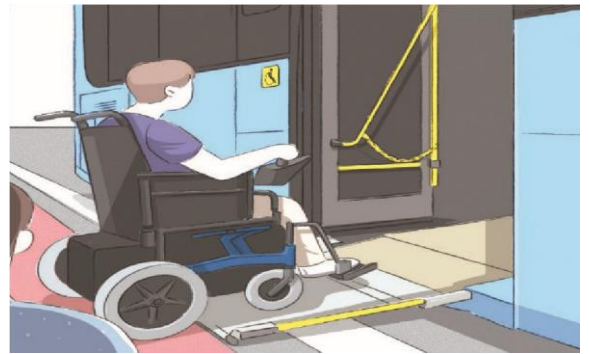
Зураг 6. Тулгуур эрхтний хөгжлийн бэрхшээлтэй иргэний нийтийн тээврийн хэрэгсэлд суух, буух нөхцөлийг хангасан тавцан (Жишээ зураг)
